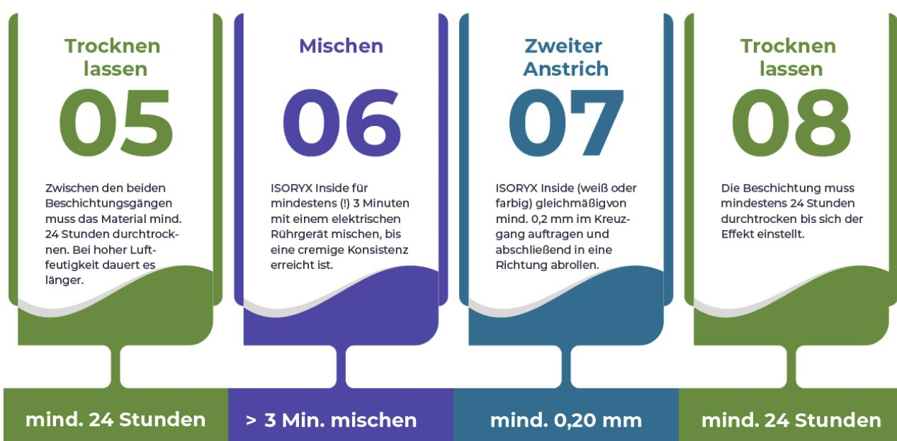
Hinweis: Alle Angaben zur Trocknung unter Normalbedingungen (+ 20°C / 65 % Luftfeuchte), tiefere Temperaturen und / oder höhere Luftfeuchte verlängern diese Zeit.
